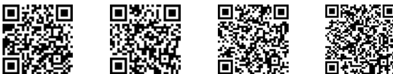
Obr. 2. QR kódy adresy http://frcatel.fri.uniza.sk/~beerb s rôznymi úrovňami schopnosti opravy chýb (úrovne L, M, Q, H zľava doprava) vygenerované pomocou generátora Morovia – Free online QR Code Maker
